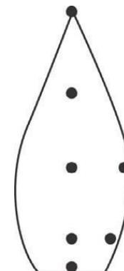
Рис. 1. Точки измерения температуры пламени
